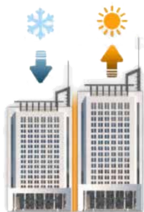
Dilatation et contraction des structures
